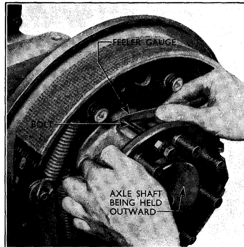
Fig. 29. Måling af bagakselaksialspillerum.
