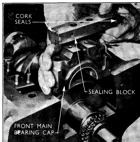
Fig. 7. Forreste hovedlejeblok er pakket med et T-formet korkstykke i hver side.
